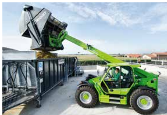
I Professional CS sono sollevatori telescopici particolarmente adatti all'impiego pesante in impianti a biogas con elevate richieste produttive.
