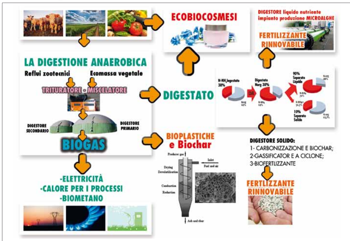
Fig. 1 - Esempio di bioraffineria in un digestore anaerobico
