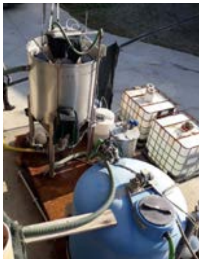
Figura 3: Vista dall'alto del prototipo: fase di cristallizzazione/sedimentazione
