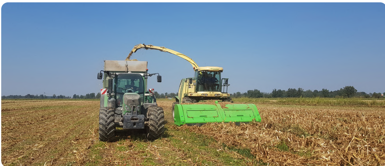
Figura 3: Cantiere B2 (singolo passaggio) Testata trinciante-flottante Figure 3: Harvesting solution B2 (single pass) floating flail head
