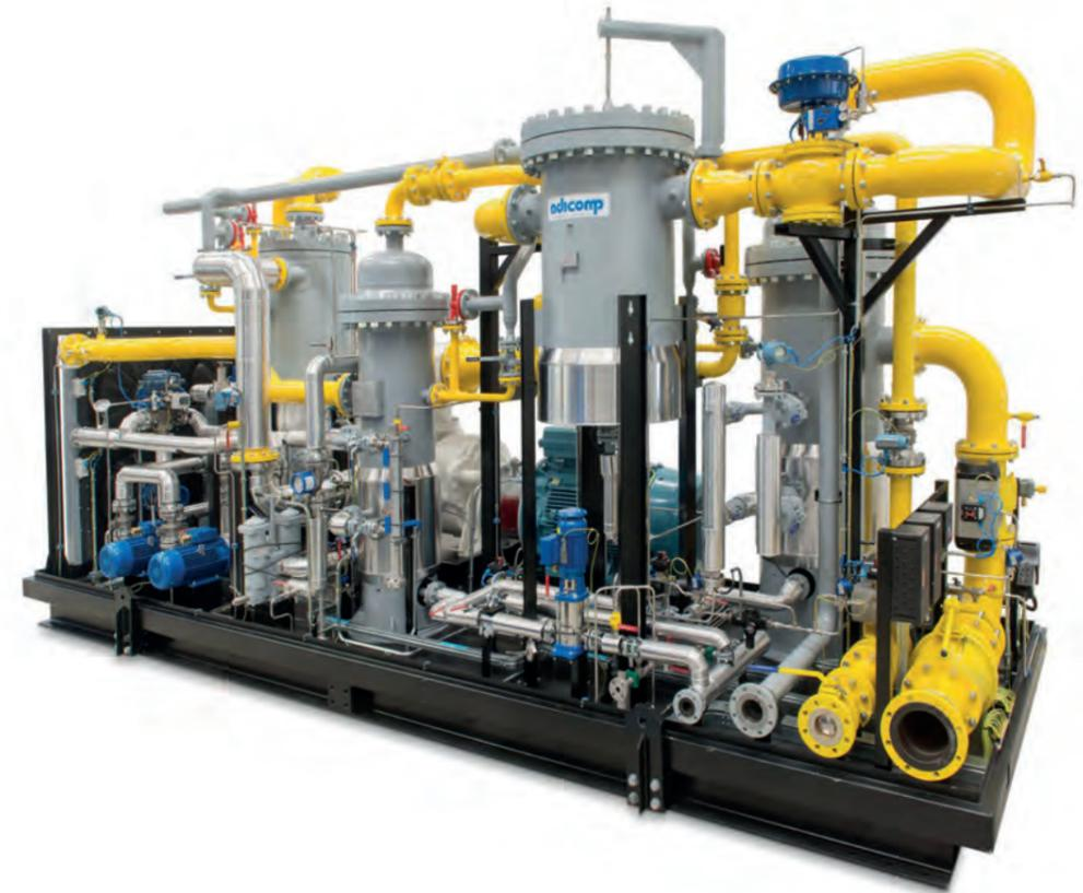
In tutto il mondo si trovano pozzi di gas maturi, e molti di questi vengono chiusi e abbandonati poiché la pressione alla testa del pozzo è insufficiente per un recupero efficiente del gas. L'utilizzo di un compressore per il gas di testa di pozzo consente ai pozzi maturi di continuare la produzione estendendone notevolmente la vita operativa. I compressori testa pozzo sono costituiti da motori elettrici o a gas accoppiati con compressori alternativi o a vite.
