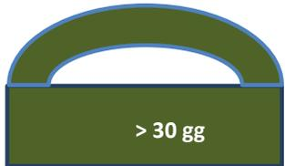
**STOCCAGGIO COPERTO:** vasca coperta *con recupero di biogas* di volume tale da contenere **la produzione di digestato tal quale o dopo separazione S/L di almeno 30 giorni**
