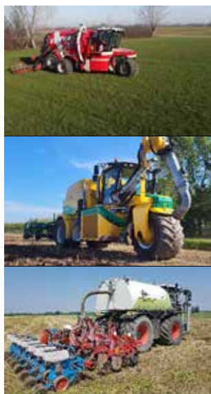
Figura 16 - Spandiliquame semoventi innovativi: caratteristiche tecnologiche.
