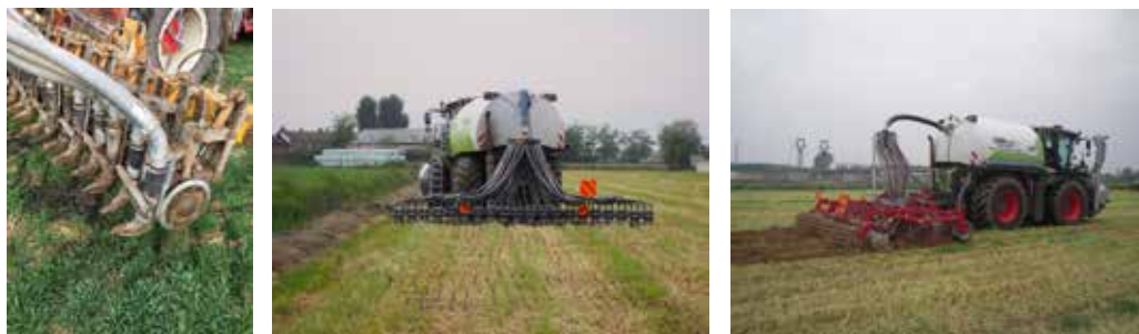
Figura 18 - Sistemi per la distribuzione sottosuperficiale: a solco aperto (a sinistra e al centro); a solco chiuso (a destra).
