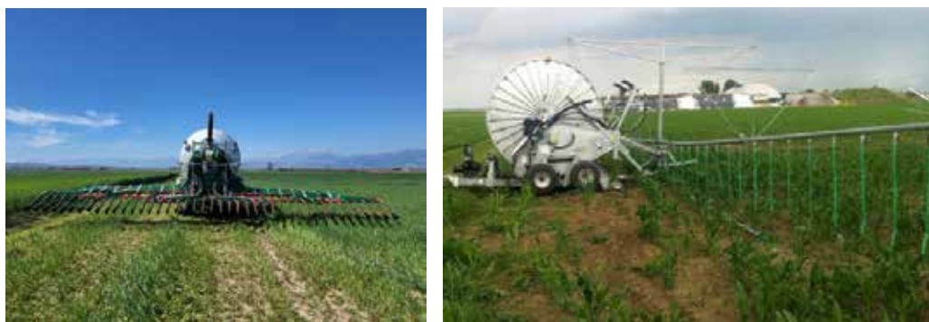
Figura 21 - Sistemi di distribuzione superficiale rasoterra.
