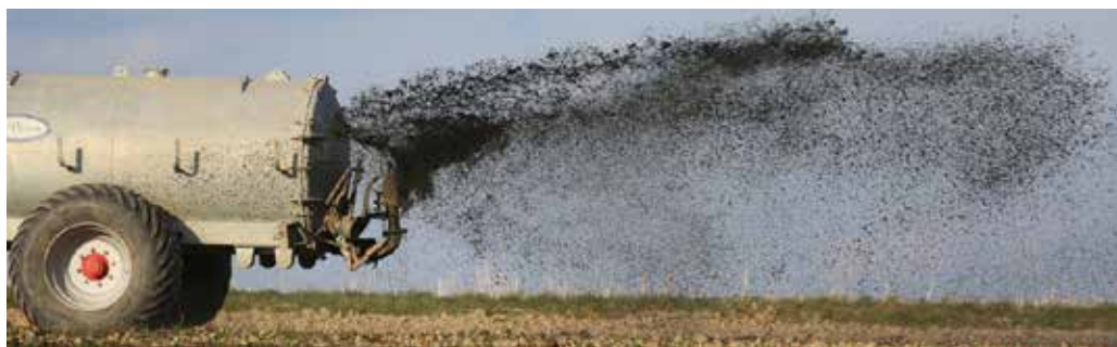
Figura 20 - Sistemi convenzionali di distribuzione superficiale di cui si raccomanda la sostituzione con sistemi a minor impatto.
