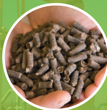
Postrattamento Pellet di digestato
